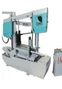
Двухколонные полуавтоматические для резки под прямым углом
