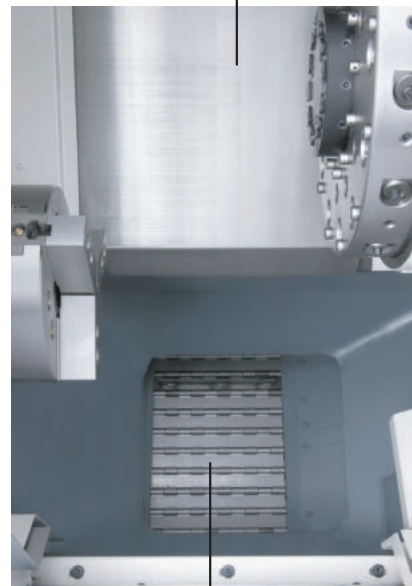
Большое отверстие для удаления стружки
