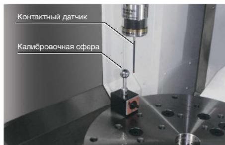
Автоматическая настройка выполняется с использованием контактного датчика и калибровочной сферы
