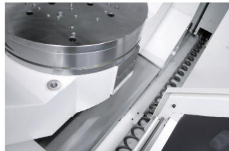
Встроенная система удаления стружки (шнекового типа)
